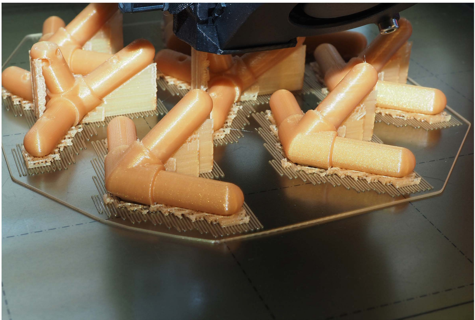
die knotensets werden polyederweise gedruckt also in 24 einzelnen aufträgen
