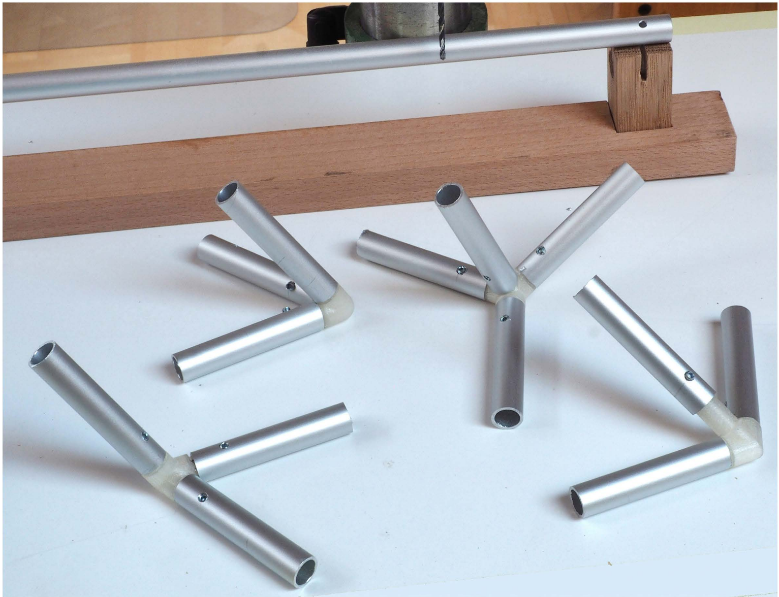
oben: hinten die lehre für die bohrungen und gewinde, vorne die ersten drucke für den funktionstest.
