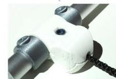
mit je einer metallschraube M3x10 mit einfachem schlitz und zylinderkopf druckzeit 1 std 2.5 std maschinenarbeit für obiges stück 20 rp
