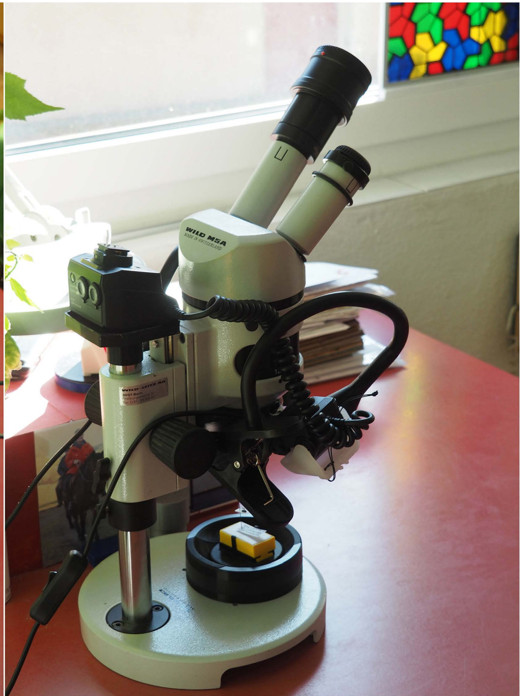
50211 keine 20.- fr pro stück kostende binokular-ledleuchten von der ikea ersetzen die stets brennend heiss gewordene alte leuchte und den alten trafo 13.2.2024 frs
