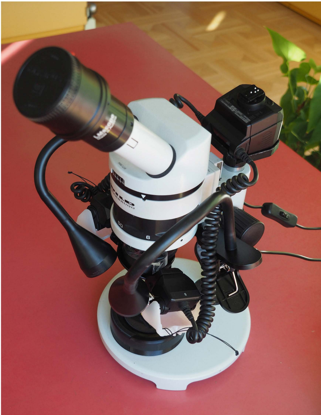
50211 keine 20.- fr pro stück kostende binokular-ledleuchten von der ikea ersetzen die stets brennend heiss gewordene alte leuchte und den alten trafo 13.2.2024 frs
